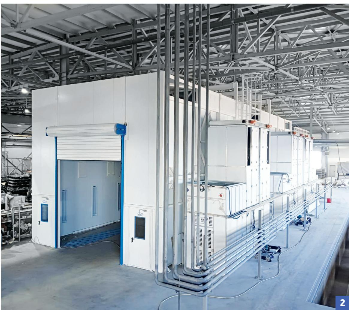
**1** 3-х секционная окрасочно-сушильная камера для каркасов кабин а/м «КАМАЗ», г. Н. Челны.
