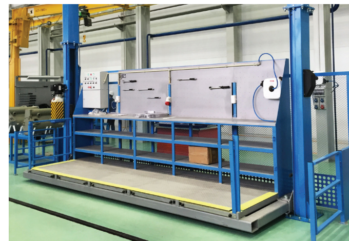
Лифтовая площадка SPK для монтажных работ
