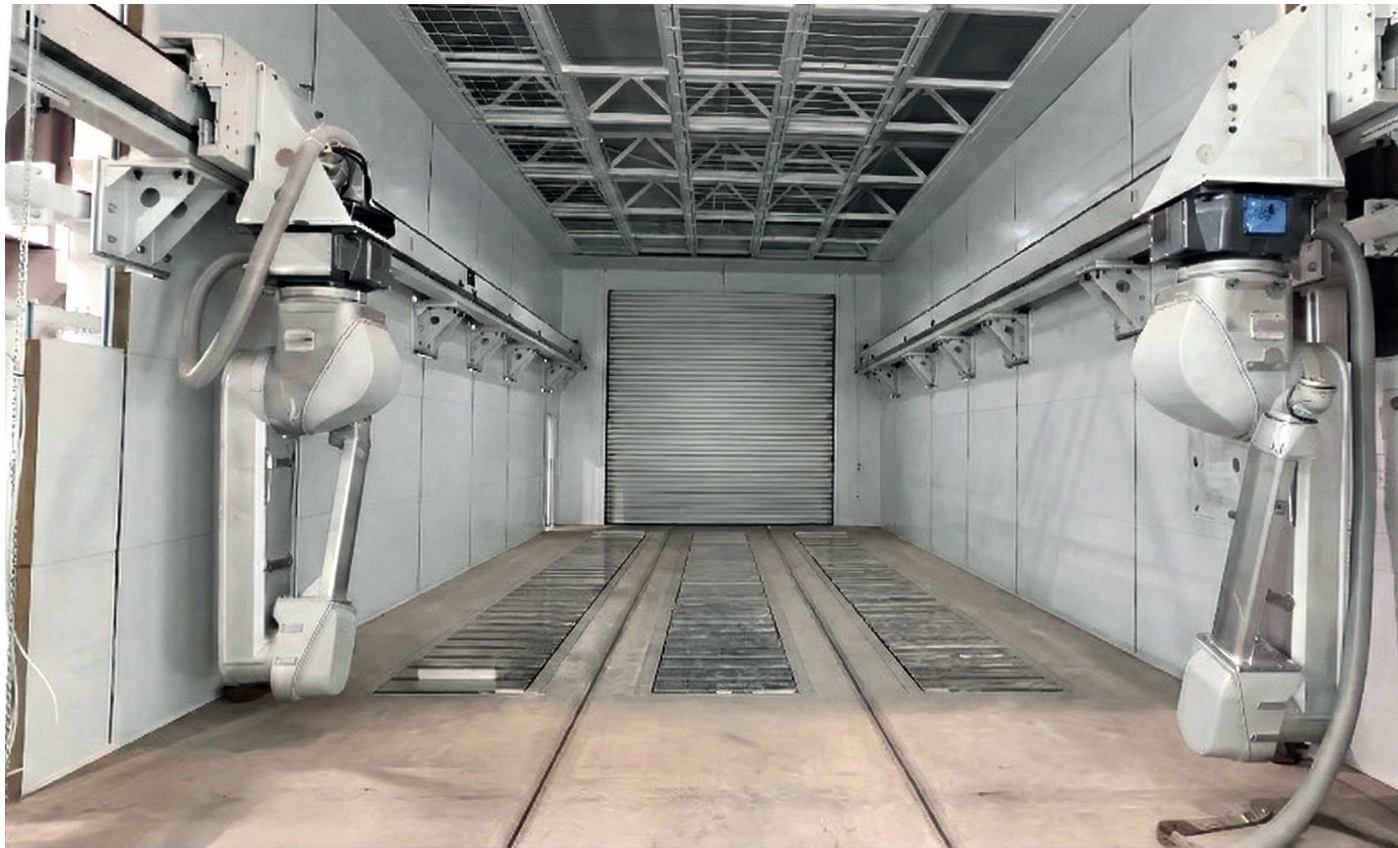
Роботизированные окрасочные камеры с 7-осевыми роботами
