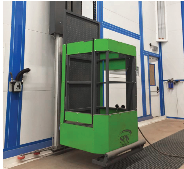
ПНЕВМАТИЧЕСКАЯ ПОДЪЕМНАЯ ПЛАТФОРМА ДЛЯ ПОКРАСОЧНЫХ РАБОТ SPK
