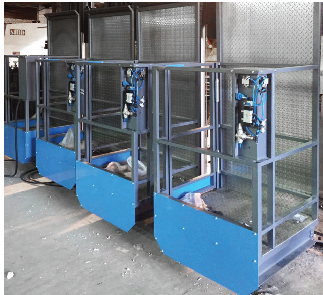
ПНЕВМАТИЧЕСКАЯ ПОДЪЕМНАЯ ПЛАТФОРМА SPK ДЛЯ ПОКРАСОЧНЫХ РАБОТ SPK
