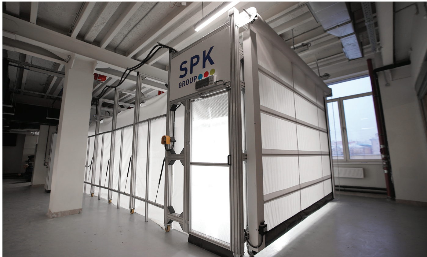
Окрасочно-сушильная камера телескопического типа SPK-SCB(Fx)-7.4.4, г. Москва
