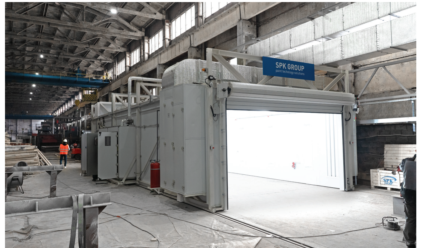
Мобильная окрасочно-сушильная камера SPK-SCB(M)-14.5.3, г. Н. Новгород
