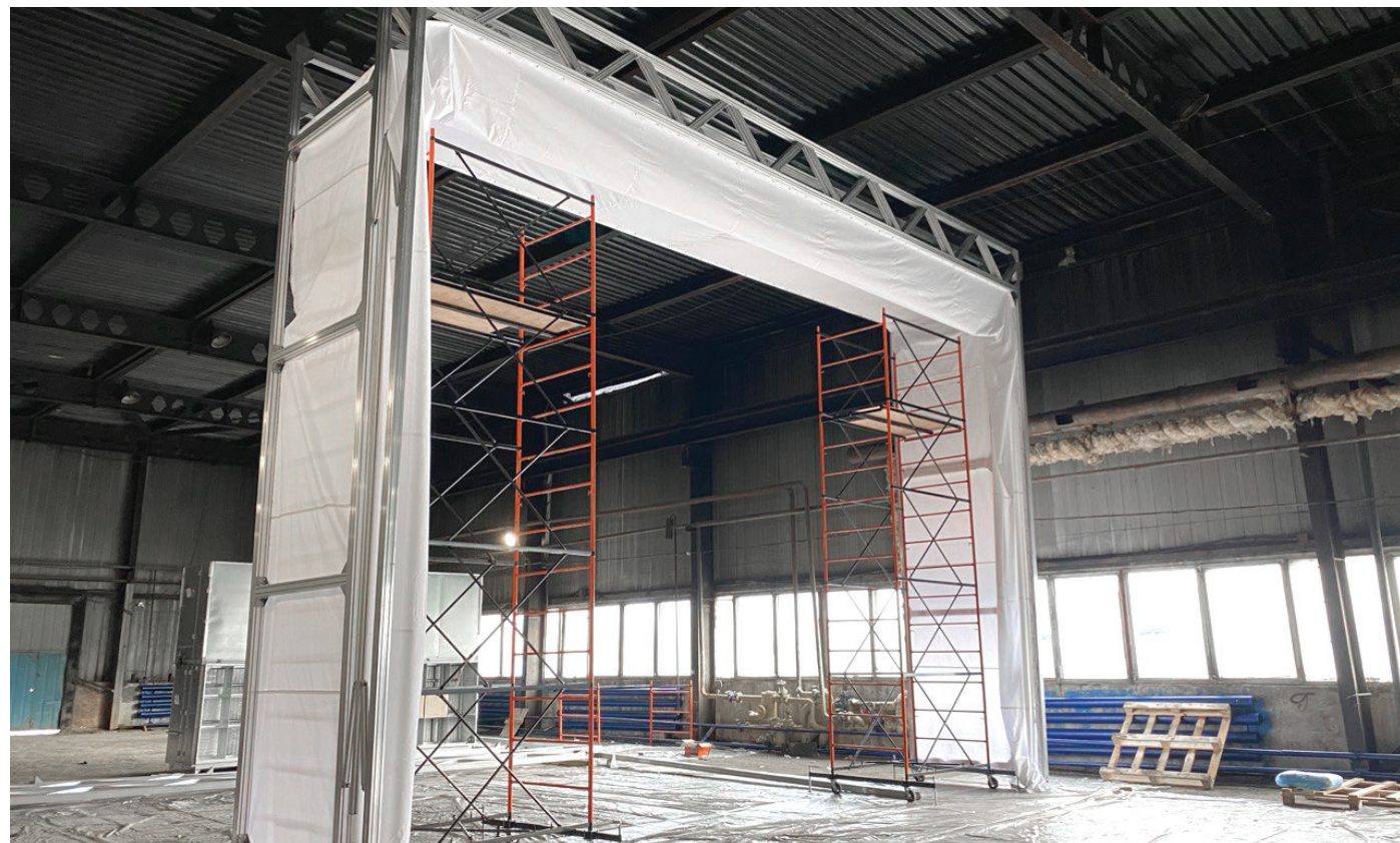
Складная окрасочная камера SPK-SCB(Fd)-22.10.7, г. Шарджа (ОАЭ)
