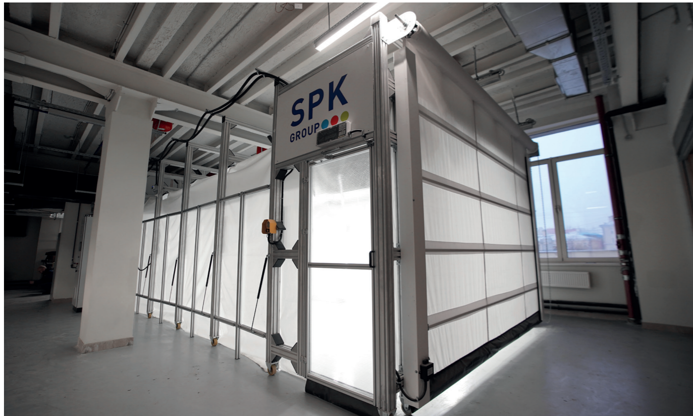
Окрасочно-сушильная камера телескопического типа SPK-SCB(Fx)-7.4.4, г. Москва
