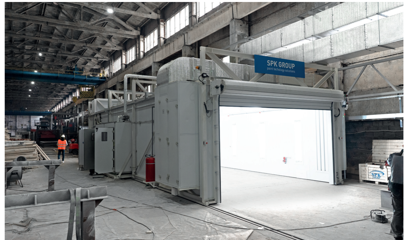
Мобильная окрасочно-сушильная камера SPK-SCB(M)-14.5.3, г. Н. Новгород
