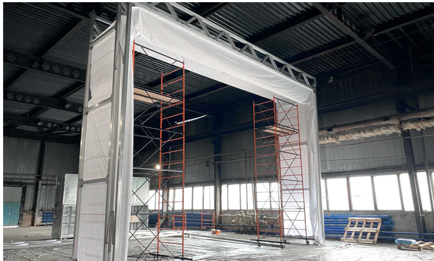
Складная окрасочная камера SPK-SCB(Fd)-22.10.7, г. Шарджа (ОАЭ)
