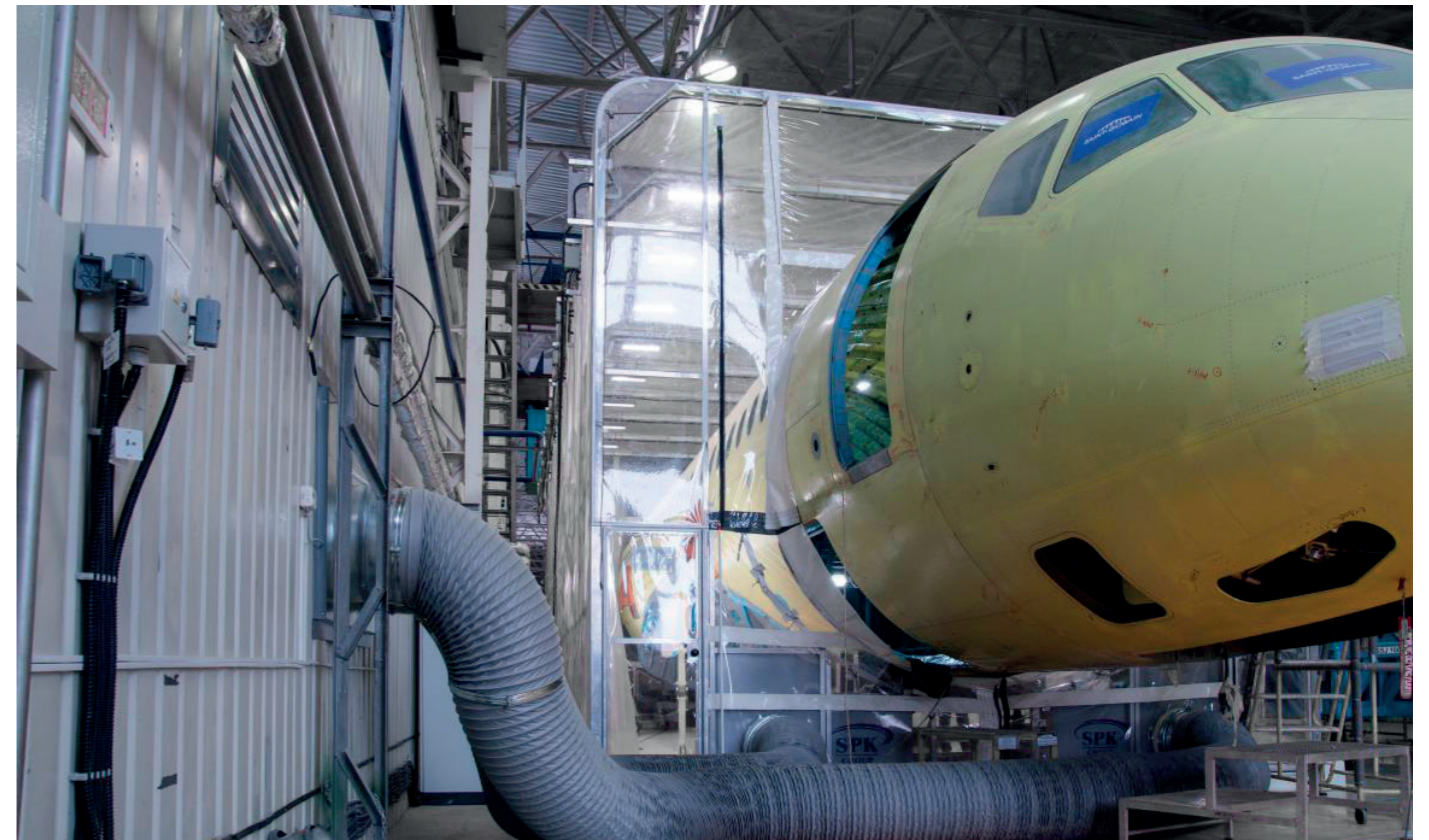
Телескопическая камера для окраски самолетов гражданской авиации SPK-14.6.6, г. Комсомольск-на-Амуре
