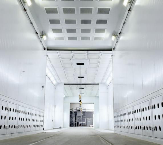
Линия подготовки и окраски обеспечивает механическую подготовку поверхности дробью, маскировку изделия перед грунтовкой, ручную окраску изделий в 3 слоя и сушку изделия. Состав комплекса: 2 камеры подготовки поверхности SPK-12.6.5, 3 окрасочные камеры SPK-12.6.5, 2 сушильные камеры SPK-11.4.5.
