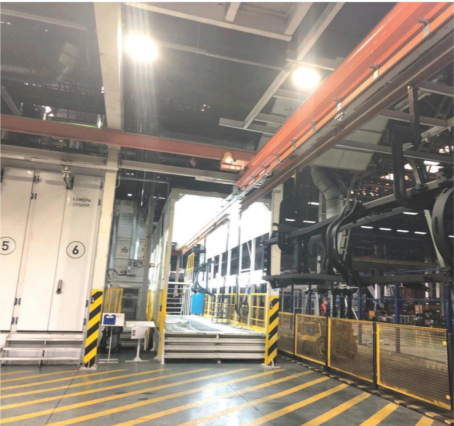
Комплекс предназначен для подготовки поверхности, окраски и сушки рам грузовых автомобилей, включая следующие операции: протирка, окраска, сушка при повышенной температуре, охлаждение, дефектовка. Комплекс состоит из шести камер и двух зон, расположенных параллельно друг другу и соединенных между собой верхней транспортной системой, представляющей собой цепь подвесных кранов. Размеры занимаемой комплексом площадки составляют 72x19 м.
