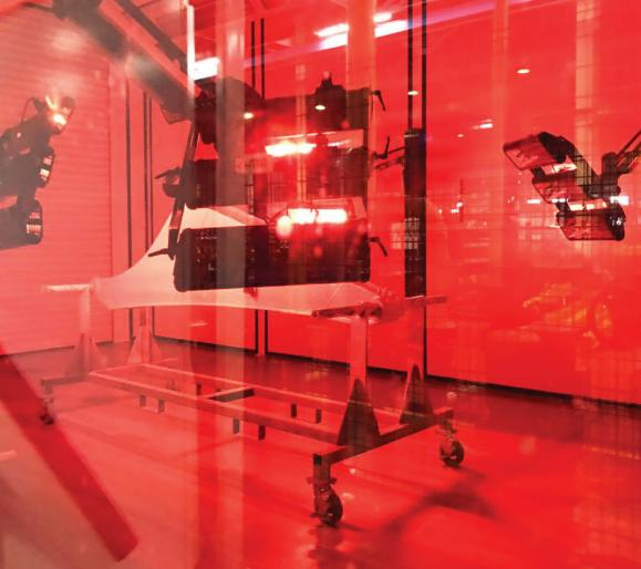
В окрасочно-сушильной камере обеспечиваются условия для нанесения на изделия ЛКМ. Камера инфракрасной сушки предназначена для высокоеффективной сушки ЛКП, не предназначена для проведения окраски.
