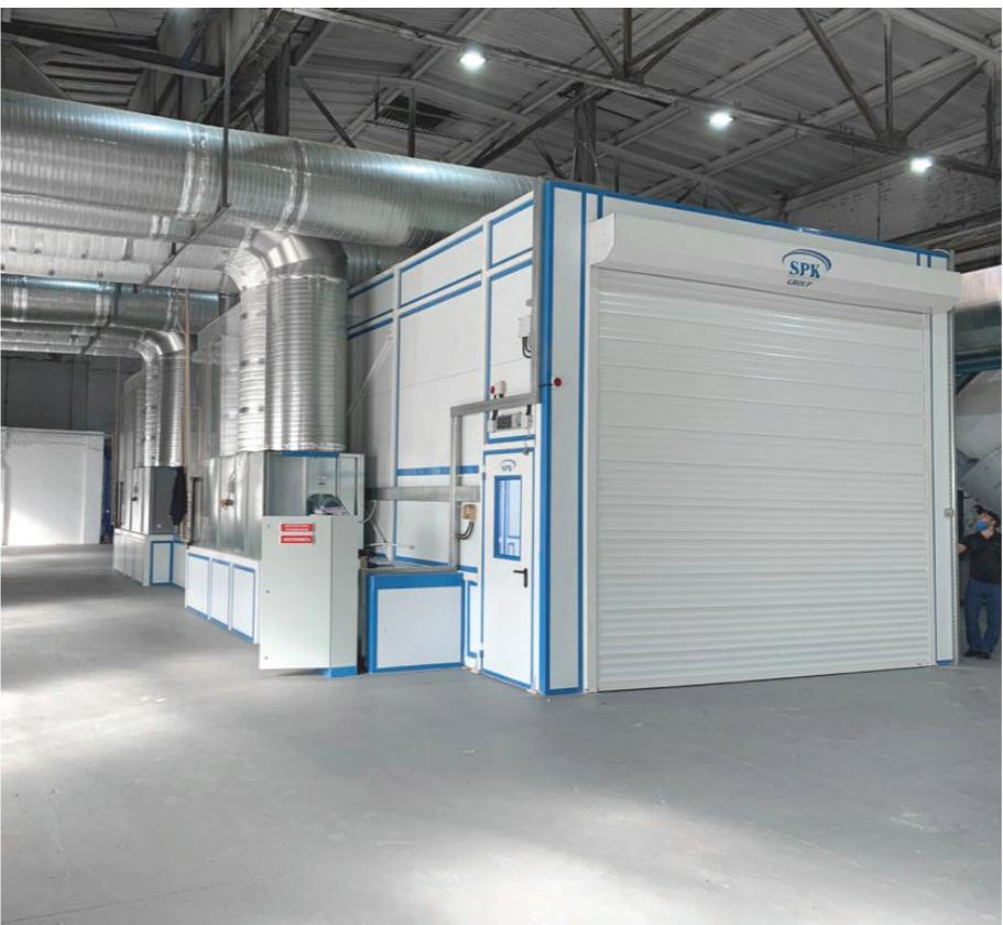
2 подъемно-секционных ворот 4100x4100 мм. Вытяжка – через 2 канала в полу. Внутренние размеры: 18000x5000x3800 мм. 2 секции. Двое роллетных ворот 4200x3700 мм. 4 сервисные двери. Приток – полный потолочный, вытяжка – в 2 боковые стены. 4 вентагрегата на 19000 м<sup>3</sup>/ч. Система фильтрации на притоке и вытяжке. Энергоноситель – природный газ. 4 воздушных теплообменника. Освещение – верхний и боковой пояса светильников во взрывозащищ. Управление режимами работы камеры – с контроллера.
