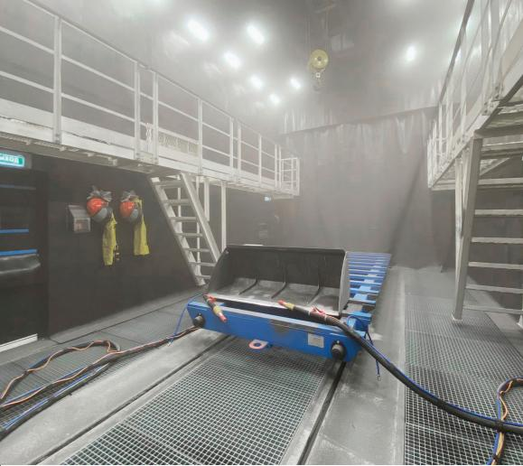
2 комплекта защиты оператора абразивоструйной установки. Максимальная мощность электропотребления - ок. 39 кВт. Максимальное потребление сжатого воздуха – ок. 17 м<sup>3</sup>/мин. Изделие перемещается в камеру на рельсовой тележке с помощью механизированного средства – электрического толкателя.
