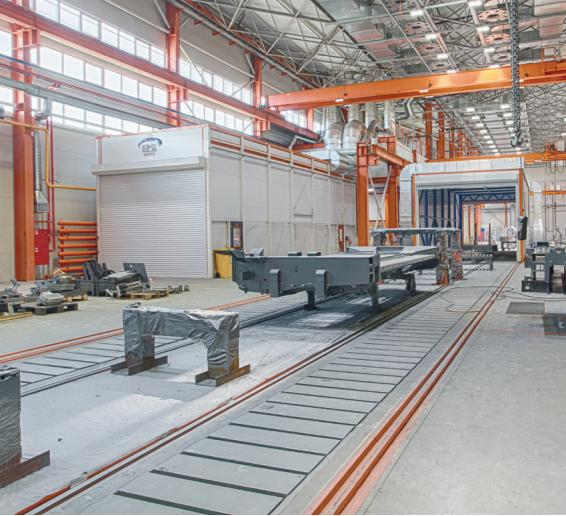
Покрасочный участок дополнен передвижной сушильной камерой SPK-15.5.3. Пере- мещается камера сушки на индивидуальном рельсовом пути, имеет 4 рабочих положения. Также предусмотрена камера обезжиривания и фосфатирования SPK-15.5.5 для совмещенного обезжиривания, аморфного фосфатирования, промывки питьевой водой и сушки при повышенной температуре.
