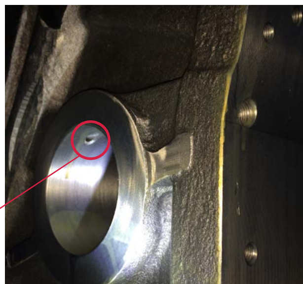
Рис. 13. Масляные каналы f) в раме со стороны махового колеса
