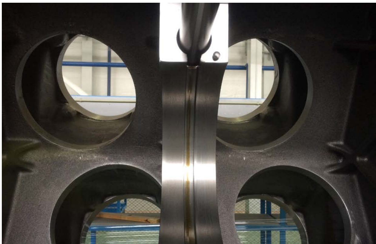
Рис. 4. Рама двигателя - вид снизу. В коренной подшипник вкручены шпильки.
