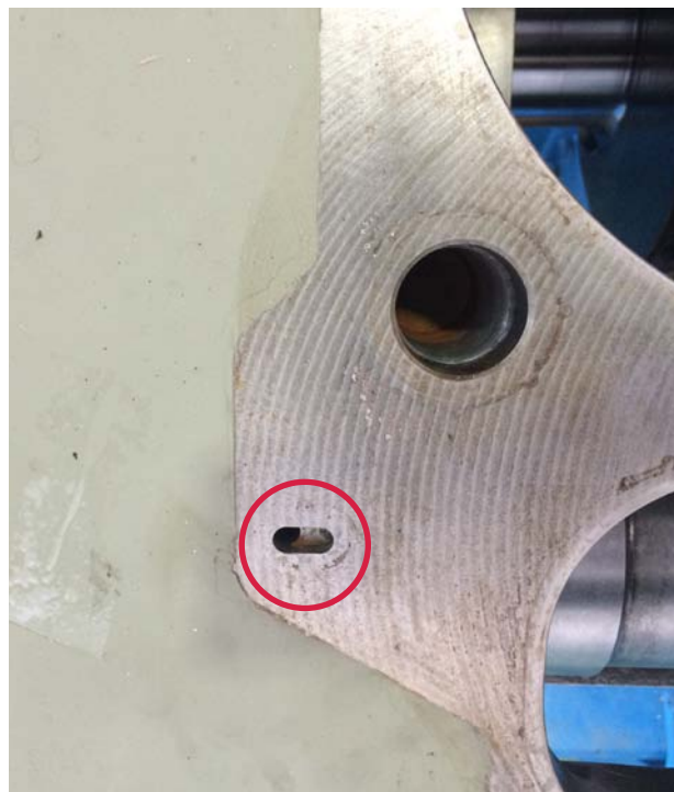
Рис. 7. Вход крайних масляных каналов а) и б).
