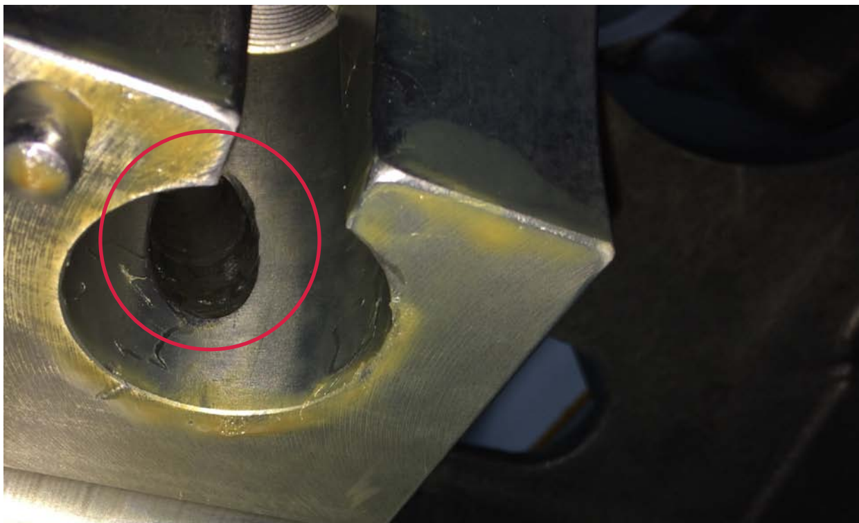
Рис. 11. Выход масляных каналов с) и d). Вид снизу.
