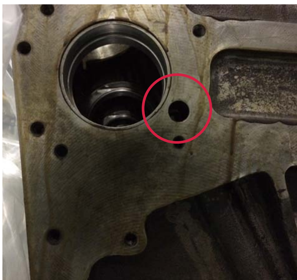
Рис. 12. Масляные каналы е) на торцевой поверхности рамы двигателя
