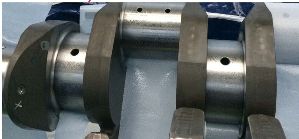
Рис. 17. Схема масляных каналов
