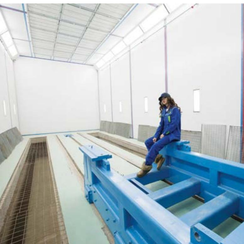
Данная камера предназначена для окраски и последующей сушки дизельных двигателей.
