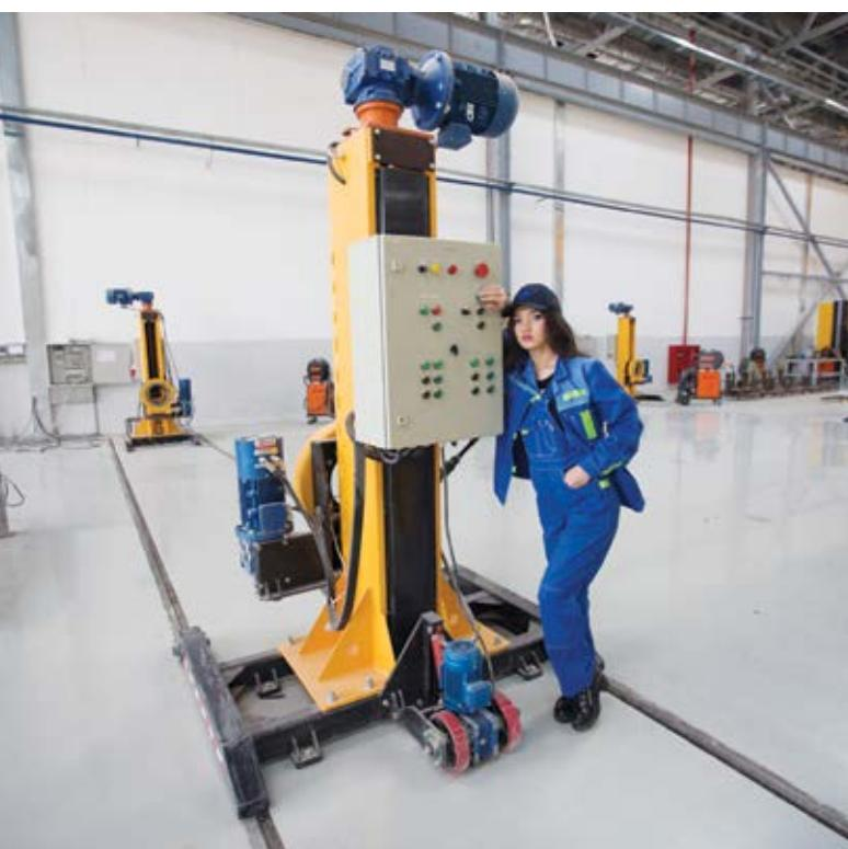
Кантователь с подъемными центрами универсальный предназначен для синхронного подъема, удержания и кантования на 360° оборудования и сварочных приспособлений.
