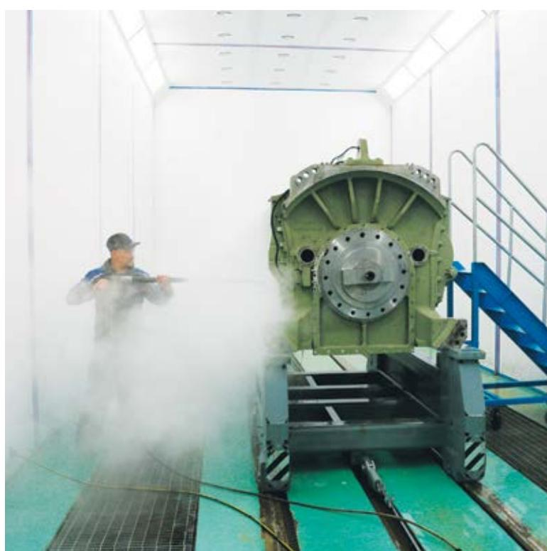
Моечная камера SPK-МА-15.5.5 предназначена для мойки различных крупногабаритных изделий водой/паром с применением моющих средств и последующей сушкой. В полном комплекте оборудования имеются функции мойки изделий водой/паром с применением моющих средств, вентиляции с удалением воздушно-капельной взвеси, фильтрации и рециркуляции сточных вод, сушки изделий и функцией контроля и управления технологическими процессами
