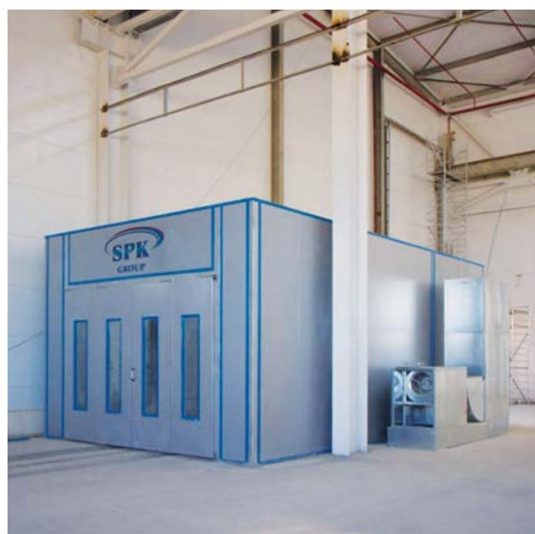
Данная необитаемая камера предназначена для струйной одноступенчатой мойки деталей дизельного двигателя при помощи горячей воды, моющих средств и дальнейшей сушки изделий
