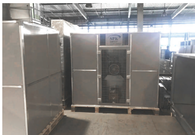
Приточно-вытяжной агрегат SPK с системой увлажнения воздуха
