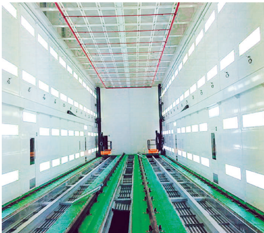
ЭЛЕКТРОВОЗО- СБОРОЧНЫЙ ЗА- ВОД. ОКРАСОЧНО- СУШИЛЬНАЯ КАМЕРА ДЛЯ ЛОКО- МОТИВОВ ALSTOM
